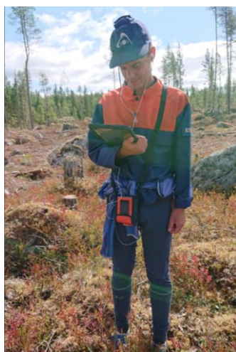
Figur 8. Manuell referensmätning av lämnade och avverkade ytor med hjälp av handburen GNSS-mottagare.
