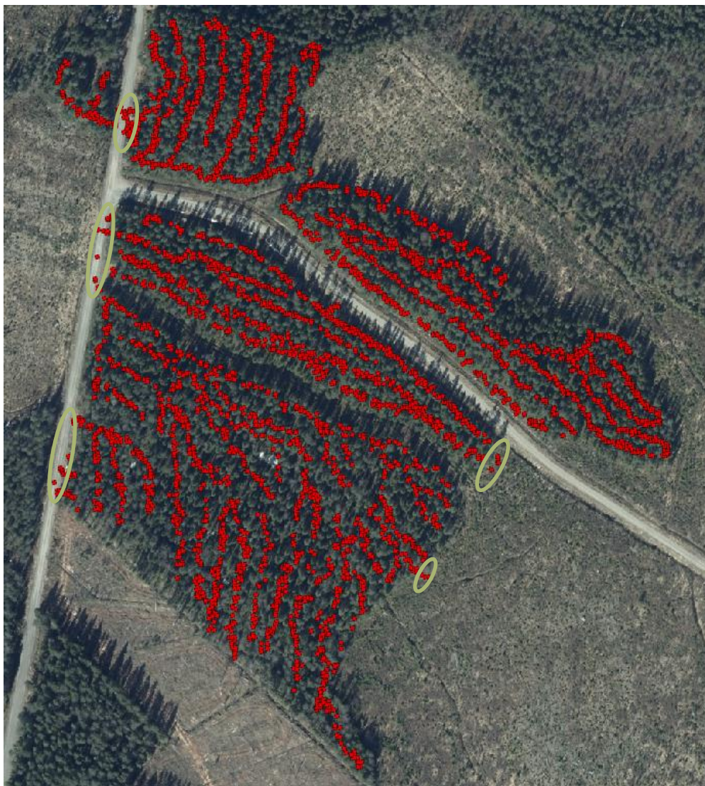
Figur 4. Karta över ett avverkningsobjekt där röda cirklar symboliserar avverkningspositioner, det vill säga basmaskinens position vid upparbetning av stammarna. Avverkningspositioner belägna inom de gröna cirklarna identifieras med hjälp av data från den nationella vägdatatabasen respektive skogliga grunddata och exkluderas vid bestämningen av den avverkade ytans utbredning.
